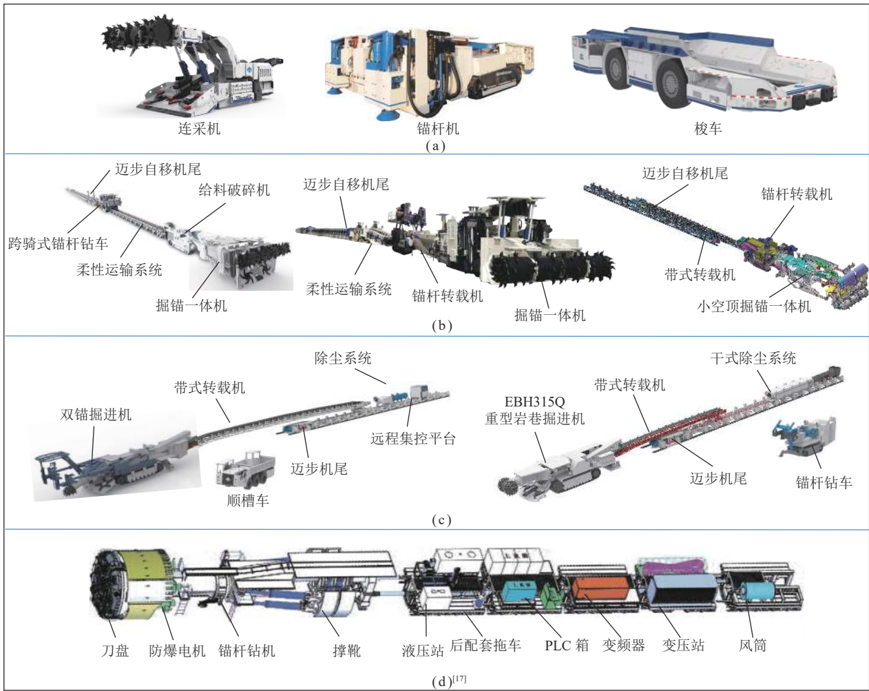
图 8 煤矿快速掘进系统成套装备配置方案
