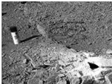
图 1 有芒硝硫磺析出的燃烧点
