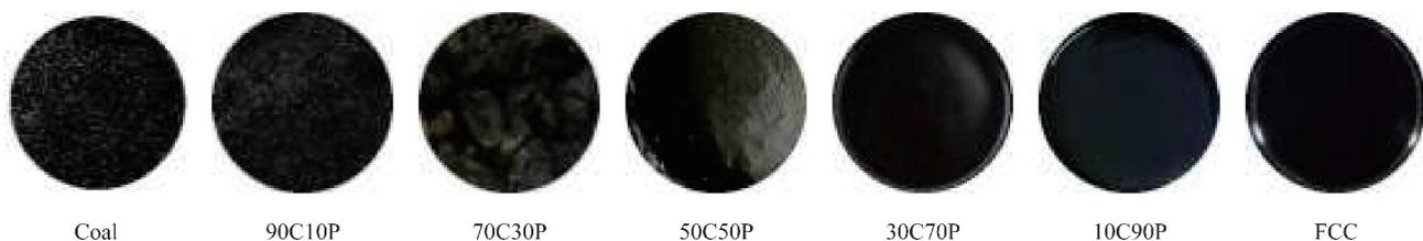
图 1 不同掺混比例的煤与 FCC 油浆形貌
