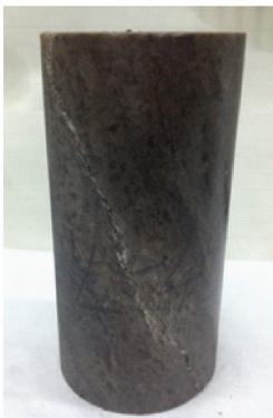
图 8 三轴压缩典型破坏模式
