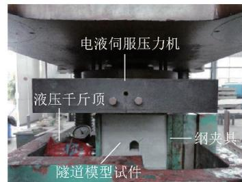
图 6 压力机及加载方式(500T)
