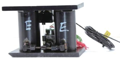
图 6 模拟支架结构与样机
