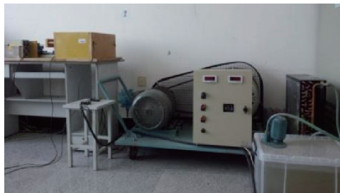
图 4 380 V/17 A 串联型故障电弧实验系统
