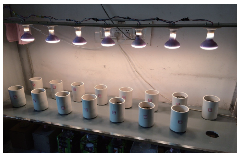
图2 自由排水柱淋滤实验装置
