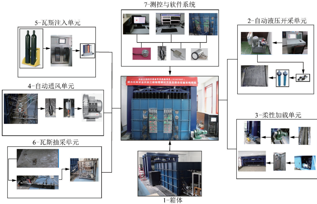
图 11 煤与瓦斯共采三维大尺度物理模拟实验系统
