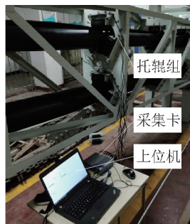
图 6 托辊接触力测试原理
