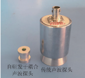
图1 自研发干耦合超声波探头与传统超声波探头
