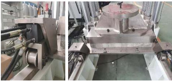
图 5 加载移动小车与加载压头结构
