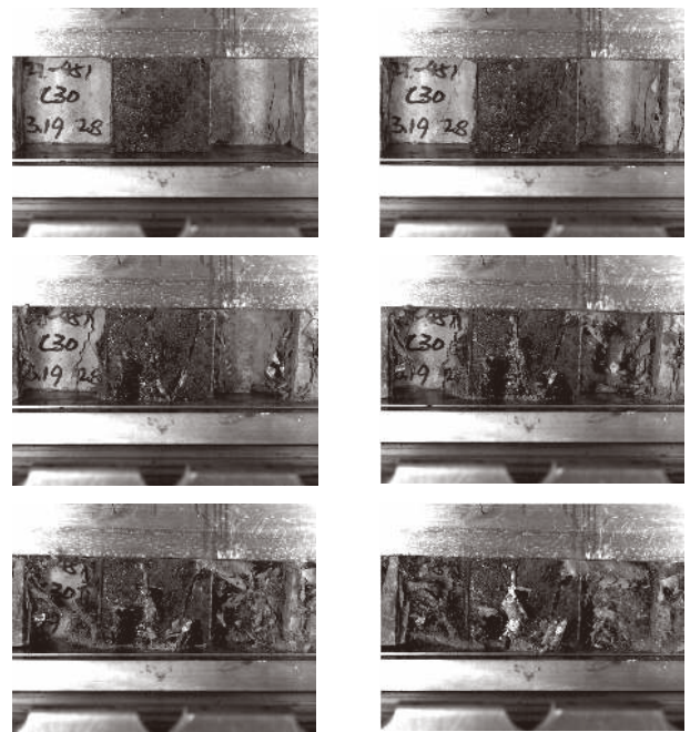
图 13 混凝土试块破坏模式
