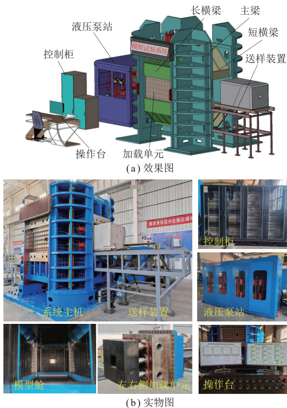
图2 煤矿巷道断层滑移型冲击地压试验系统
