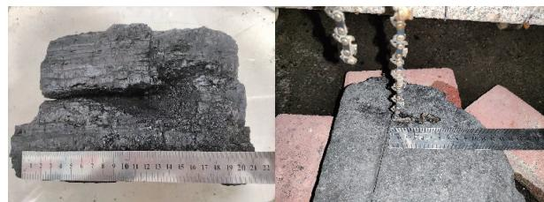
图5 柔性刀具破煤效果
