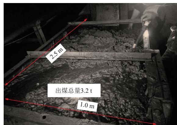
图 23 空气射流在松软煤层的冲孔试验
