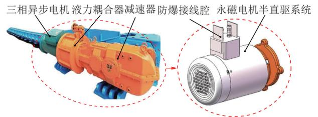
图 3 永磁电机半直驱系统升级改造方案
