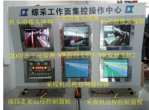
图10 综采成套试验系统与VR监测
