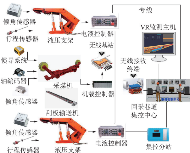
图 3 综采装备传感器构成、信息传输和集成示意
