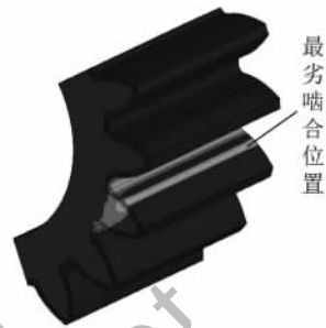
图5 渗碳齿轮的最劣啮合位置
