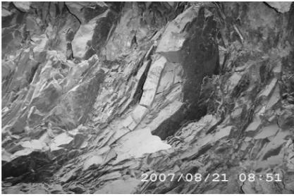
图2 围岩节理裂隙分布
