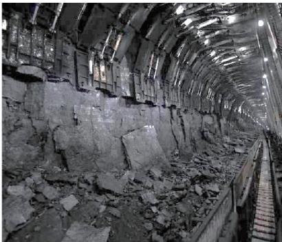
(a) 超大采高一次采全厚工作面煤壁板裂化破坏
