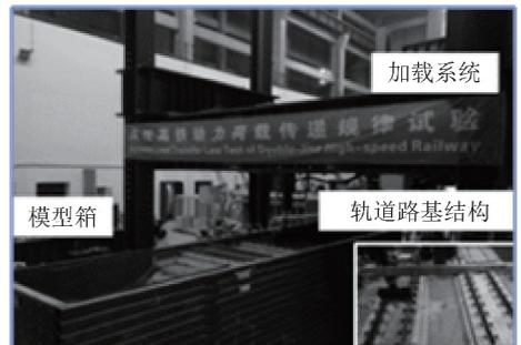
图 12 同济大学 1:4 无砟轨道路基模型
