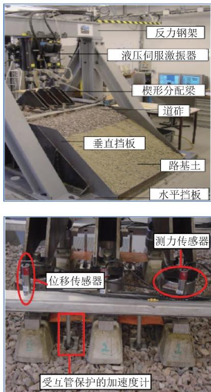
图 13 法国 1:3 有砟轨道路基模型
