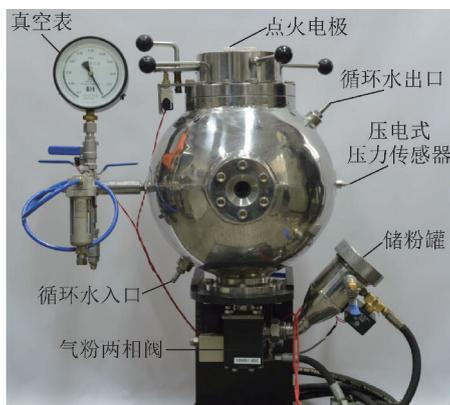
图 3 20-L 球形爆炸装置实物
