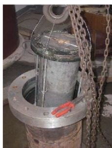
图4 安装试验试块
