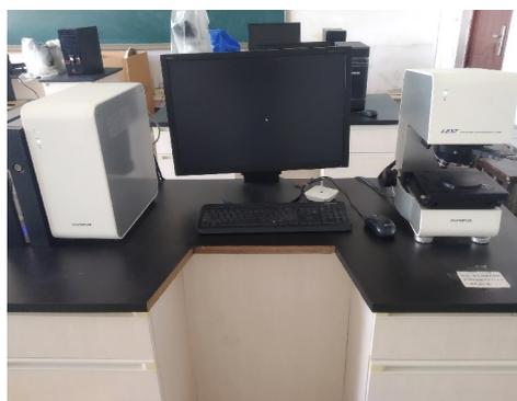
图 1 激光共聚焦扫描显微镜
