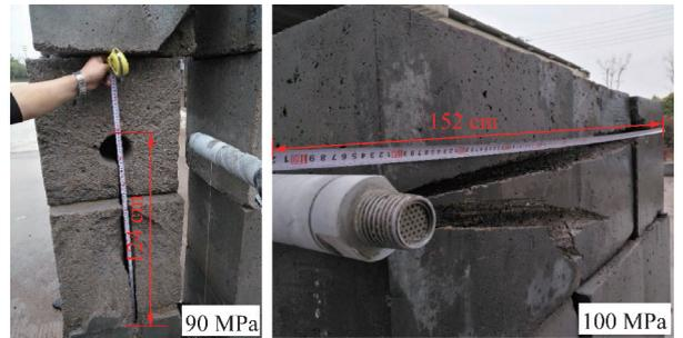
图 5 90,100 MPa 射流压力割缝深度
