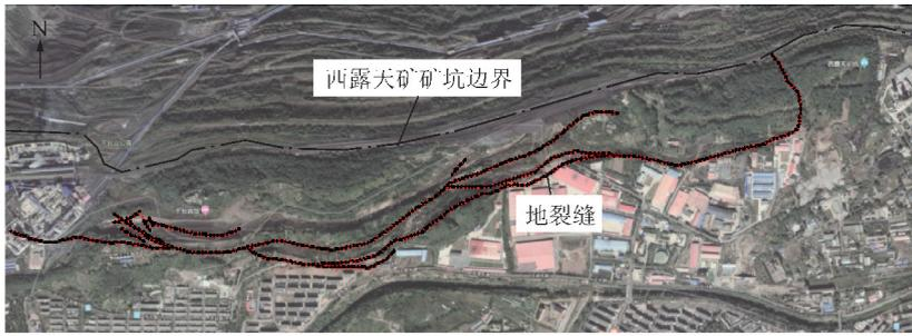
图 15 III号地裂缝位置
