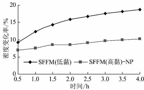
图 3 微泡沫钻井液密度变化率的对比
