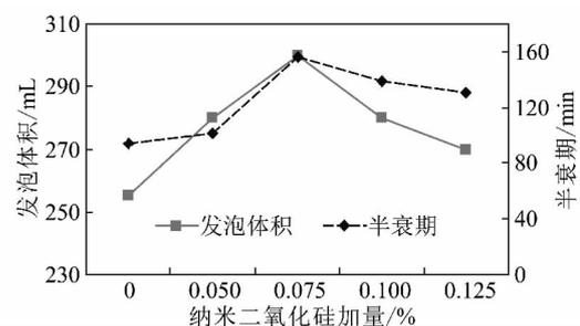
图2 纳米二氧化硅对泡沫钻井液稳定性的影响(配方②)
