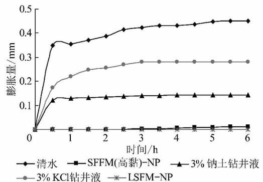
图 5 不同钻井液对煤岩膨胀性的影响曲线
