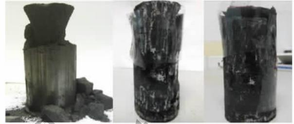
图 7 蠕变实验试件的破坏形态
