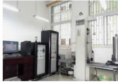
图1 RLW-2000M 微机控制煤岩流变仪
