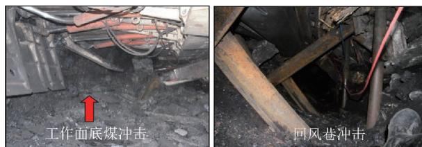
图 6 工作面底煤冲击现场照片
