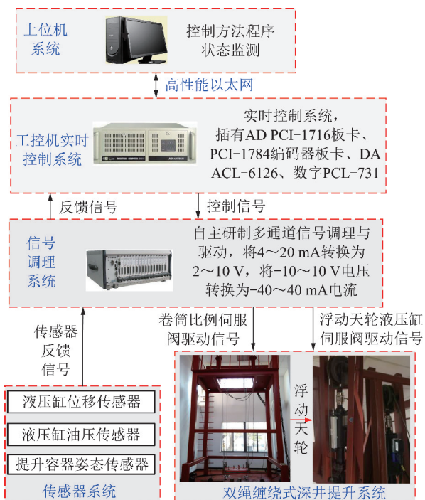
图 5 双绳缠绕式深井提升试验系统控制方案
