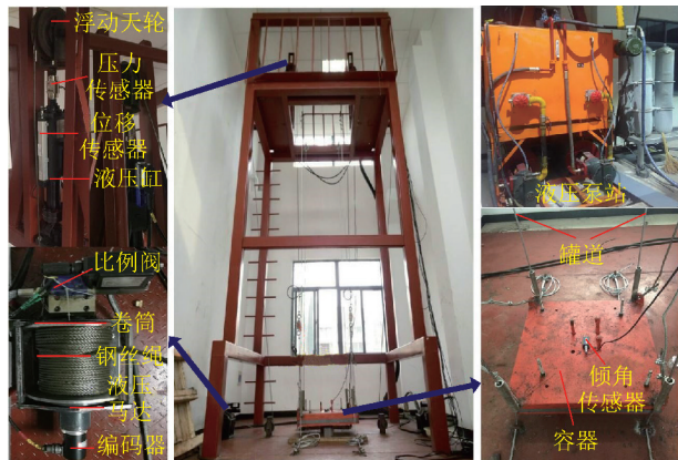
图 4 双绳缠绕式深井提升试验台
