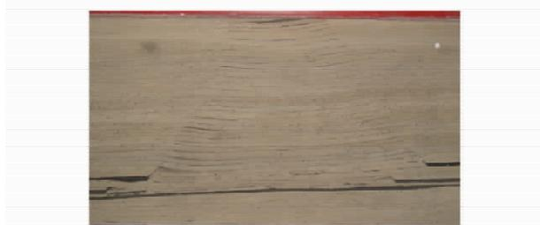
图 11 己<sub>15</sub>-31010 工作面覆岩最终垮落状况
