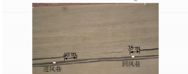
图 9 己<sub>14</sub>-31010 工作面覆岩最终垮落状况
