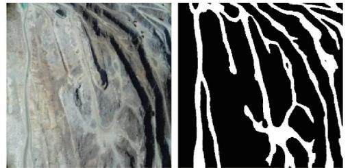
图 8 神经网络的输入和输出图像
