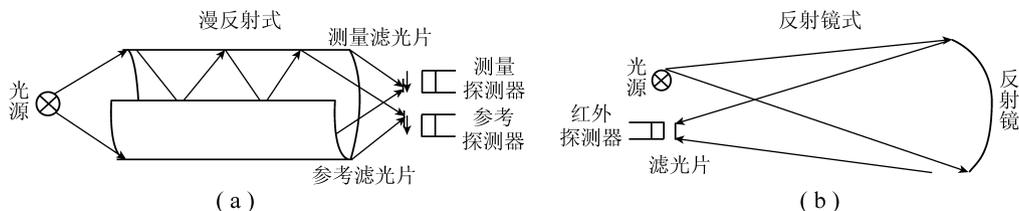
图 1 漫反射式和反射镜式光路原理
