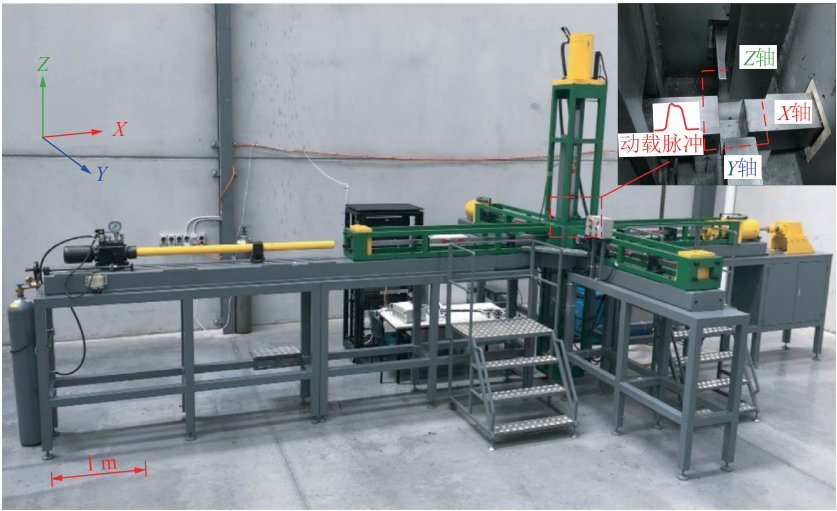
图 3 真三轴动静加载霍普金森冲击试验装置
