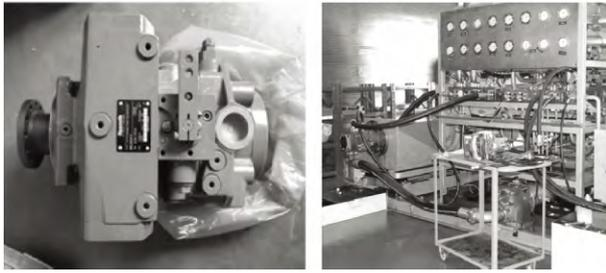
图 9 轴向柱塞泵和液压试验台
